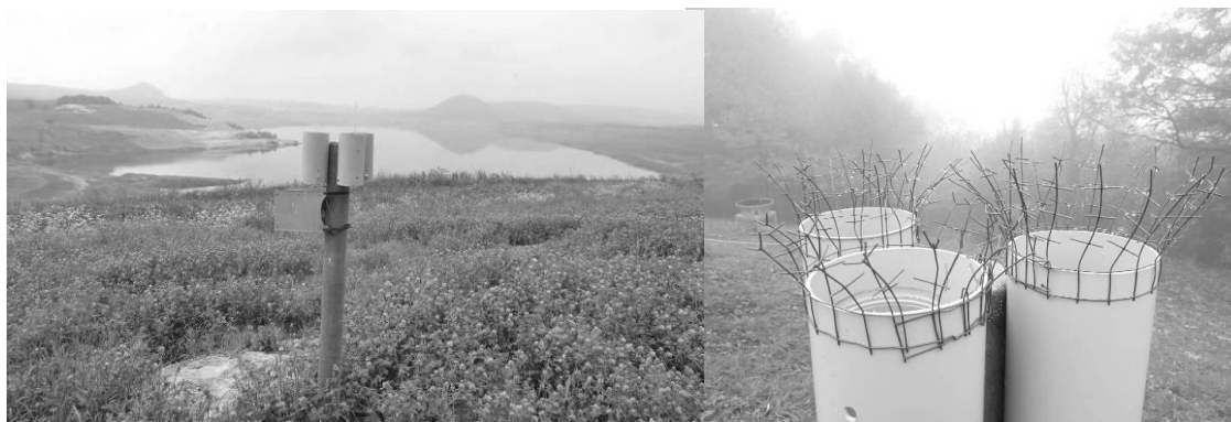
Obr. 2 Foto stativu s držáky vzorkovnic pro pasivní odběr plynů a prašného spadu
